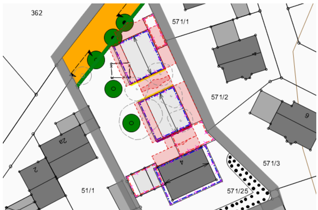
Abb. 9 Überlagerung der gesetzlichen Abstandsflächen von 0,4 H, schematische Darstellung, ohne Maßstab
